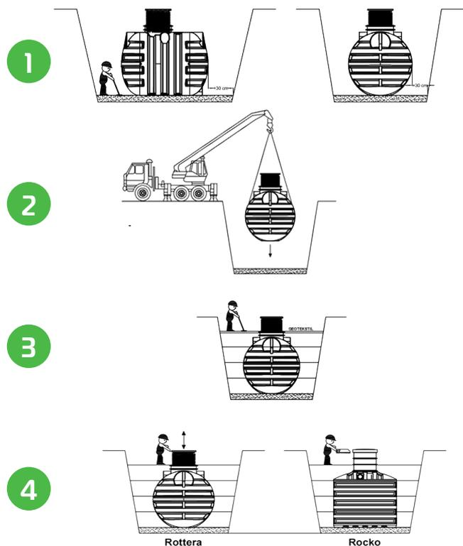
**1. FÁZE:** Půdorysná velikost stavební jámy musí být min. o 30 cm větší než půdorysné rozměry nádrže. Tvar stavební jámy by měl mít ve tvaru kvádrů se svislými okraji (dovoluje-li to struktura půdy). Dole na dně vyložíme štěrskem o zrnitosti 4 až 16 mm štěrkové lůžko, tloušťka vyloženého lůžka by měla být 10 - 15 cm, rovné, resp. vyrovnané vodováhou podélně a napříč.
